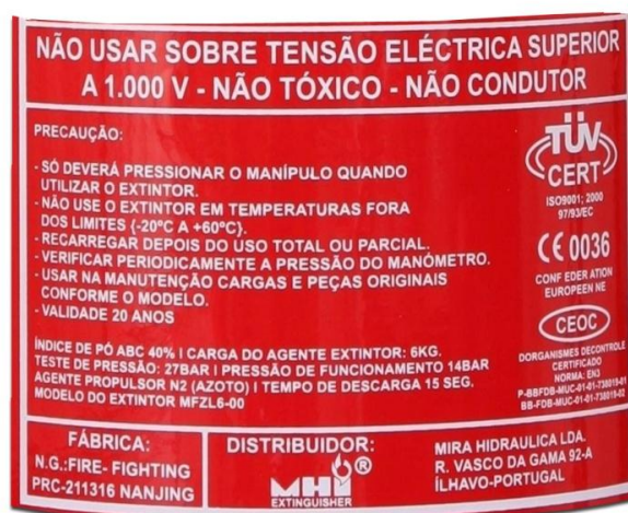
Imagem 4 – Parte inferior do rótulo do extintor de incêndios.
